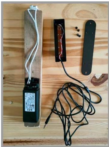
**2** Ouvrir le potentiomètre fourni avec le gradateur : 4 vis sont à retirer à l'arrière, 2 vis à l'avant. Enlever le repose-doigt pour pouvoir enlever le potentiomètre de son boîtier, le retourner puis refixer le tout. Cette opération vise à faciliter le passage du câble de commande.
