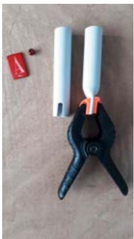
**2** Couper et poncer un angle du tube déjà aplati. Du côté opposé à l'encoche, couper et poncer d'un côté, de façon à laisser libre le mouvement. Attention à laisser une butée de façon à ce que le mouvement de plié se fasse dans un sens uniquement. Si ce n'est pas le cas on peut toujours intervenir au moment de la construction du corps qui va venir recouvrir l'ossature.
