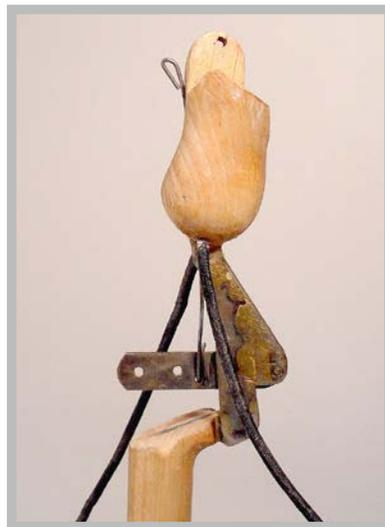
**4** La pièce de liaison est une cage brasée à partir de plats d'acier de 2 mm. Sa forme est déterminée par l'emplacement et la position neutre de la main du/de la marionnettiste et de la tête du personnage.
